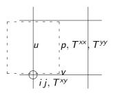
$$\rho u_{ij+\frac{1}{2}}^{n+1} = \rho u_{ij+\frac{1}{2}}^{n} - \Delta t \left( \frac{T_{i+\frac{1}{2}j+\frac{1}{2}}^{xx} - T_{i-\frac{1}{2}j+\frac{1}{2}}^{xx}}{\Delta x} + \frac{T_{ij+1}^{xy} - T_{ij}^{xy}}{\Delta x} \right).$$
